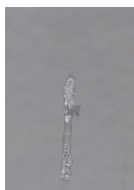
一般外墙涂料 (3H铅笔测试涂膜完全划破)
