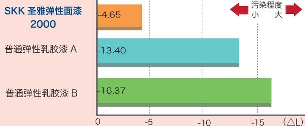
注：ΔL 变为负值代表涂膜颜色变深，负值越大颜色变化越大，耐沾污效果越差。
